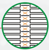
高速背板通讯 +5V模块供电
